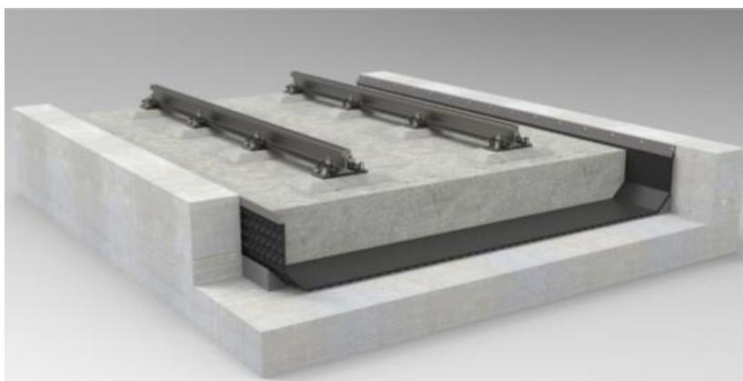
Figura 5 – Solução anti-propagação de vibrações induzidas pelo ML
