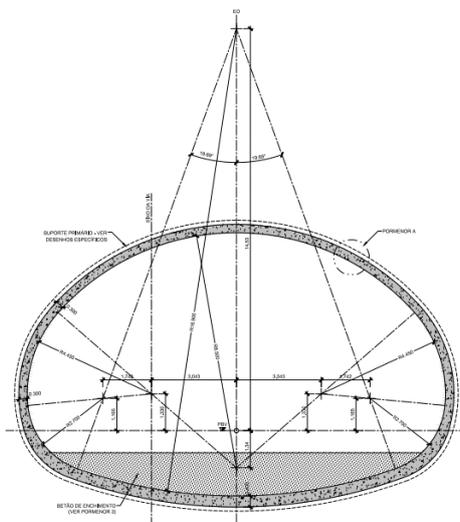
Figura 3 – Revestimento Definitivo: Túnel Término (OE7) – Secção TT.3
