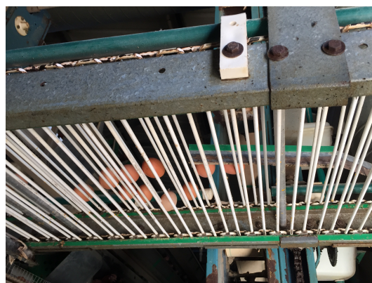
Figura 6.4 – Vista da passadeira de transporte de ovos (no interior do pavilhão 13)
