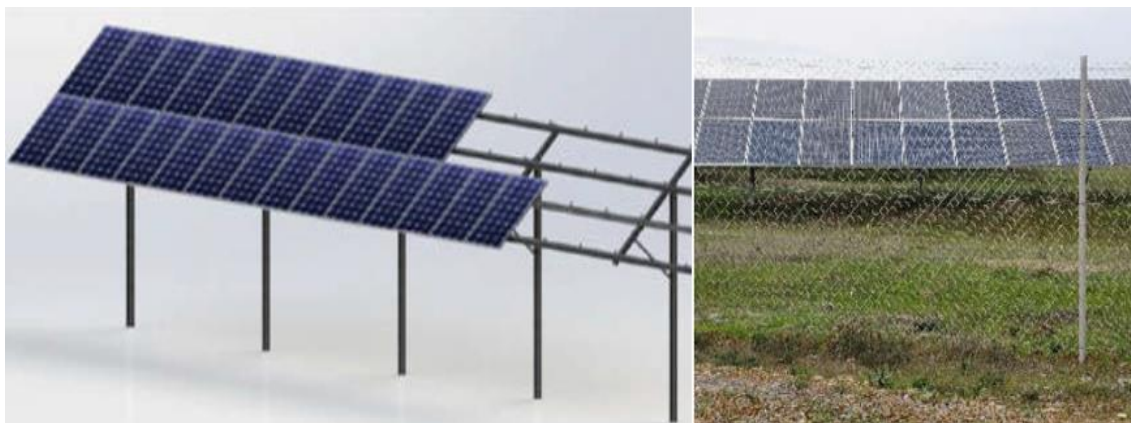
Figura 2 – Esquema tipo dos módulos e respetivas medes de suporte e vedação a instalar
