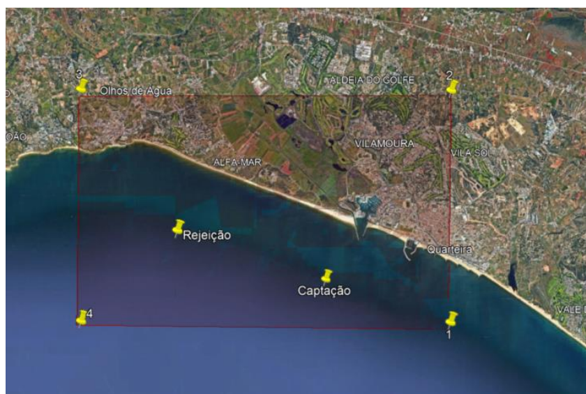
Ilustração 3. Área de obtenção dos dados com os pontos de captação e rejeição do sistema de dessalinização
