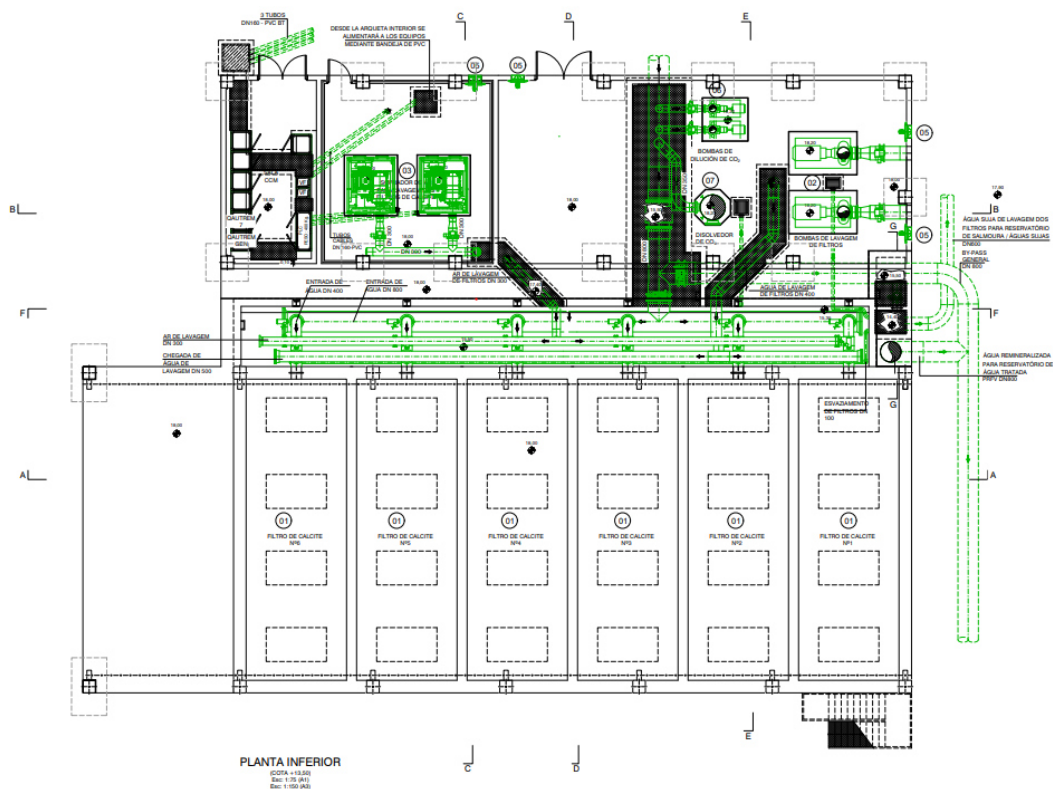
Ilustração 61. Edifício dos Filtros de Calcite - Planta
