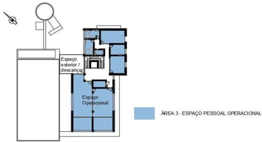
Ilustração 45. Planta de zoneamento do piso 1
