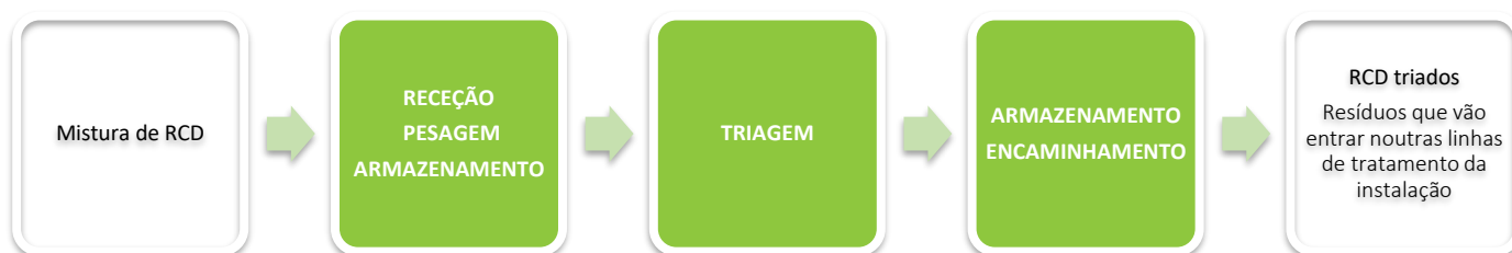
Figura 19. Fluxograma do tratamento de RCD, operação R12 B.
