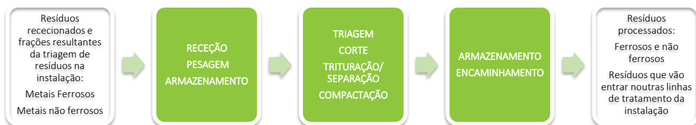
Figura 11. Fluxograma do tratamento de metais, operação R12 A.
