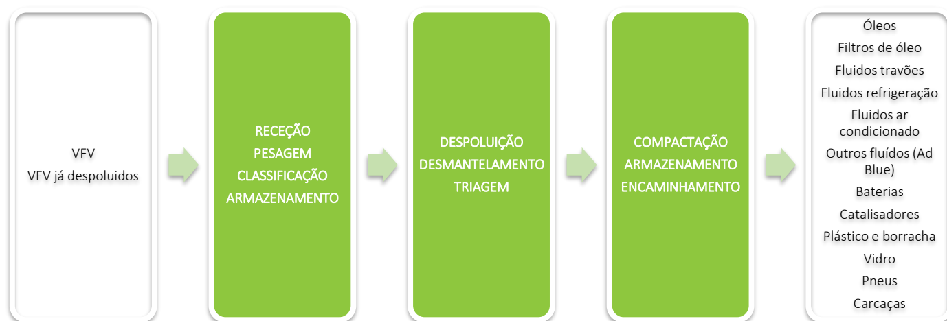
Figura 13. Fluxograma do tratamento de VFV, operação R12 F.
