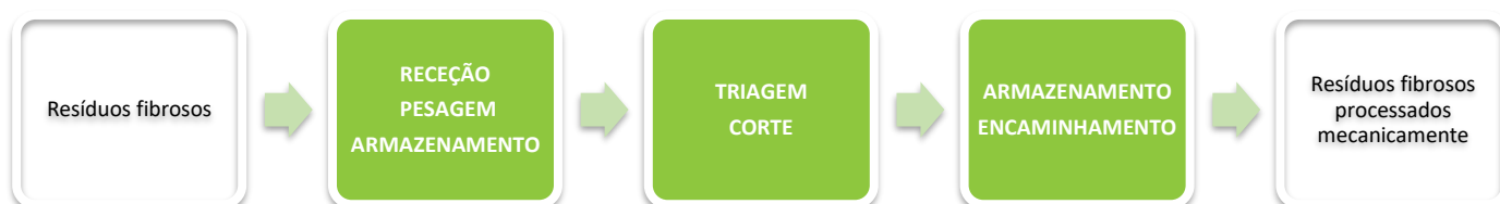
Figura 20. Fluxograma do tratamento de resíduos fibrosos, operação R12 A.
