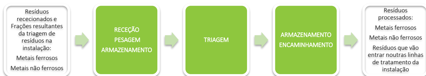
Figura 12. Fluxograma do tratamento de metais, operação R12 B.
