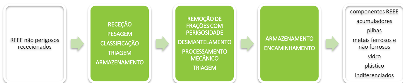
Figura 14. Fluxograma do tratamento de REEE não perigosos, operação R12 G.
