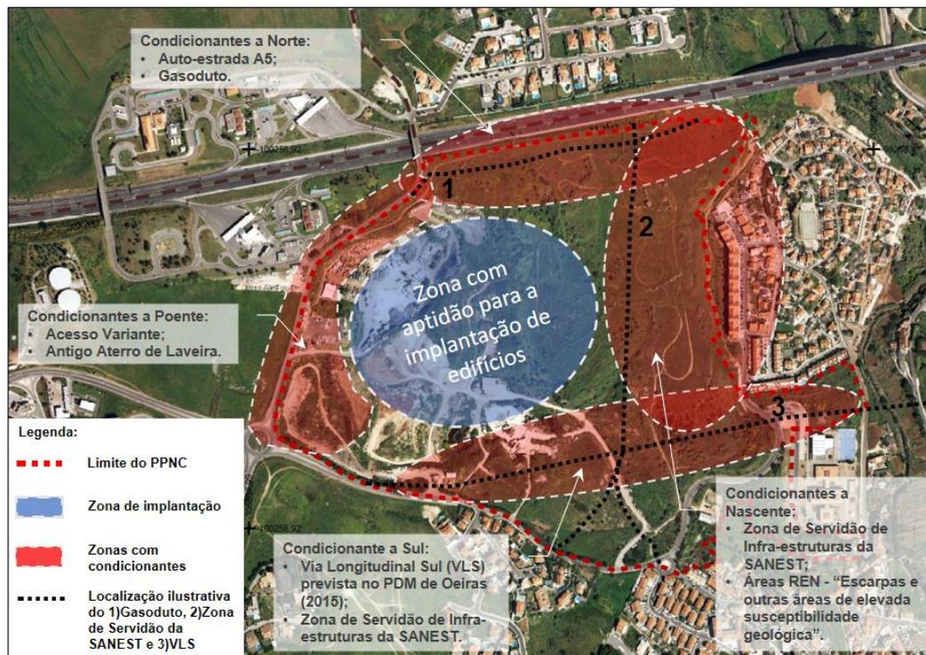
**Figura 6 - Condicionantes existentes à implantação dos edifícios**
