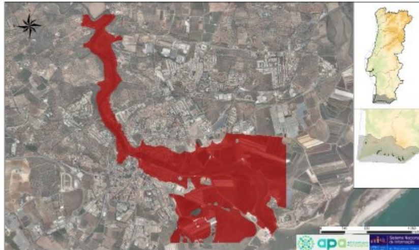
Figura 28 - Área inundada para o período de retorno de 100 anos, ARPSI de Tavira (PTRH8Gilao01)
