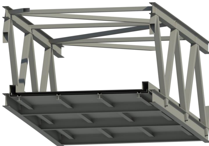
Figura 4 – Vista 3D do tabuleiro
