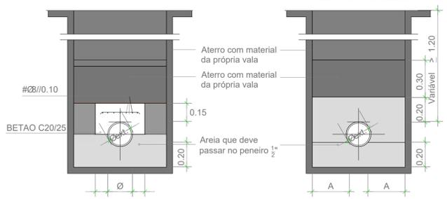
NOTA: A face inferior da vala será bem compactada (compactação superior a 85% do Ensaio Normal)
