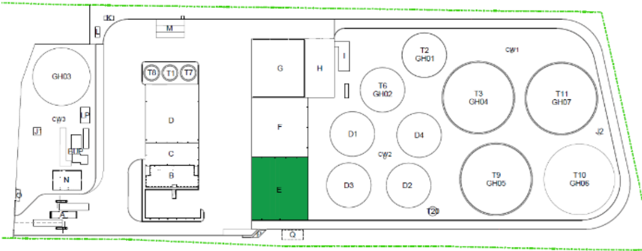
Figura 24. Localização no layout dos tanques de higienização.
