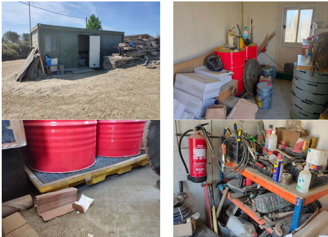
Figura 142: Registo fotográfico do local de armazenamento de óleos, de filtros usados, material absorvente usado e outros resíduos diversos.
