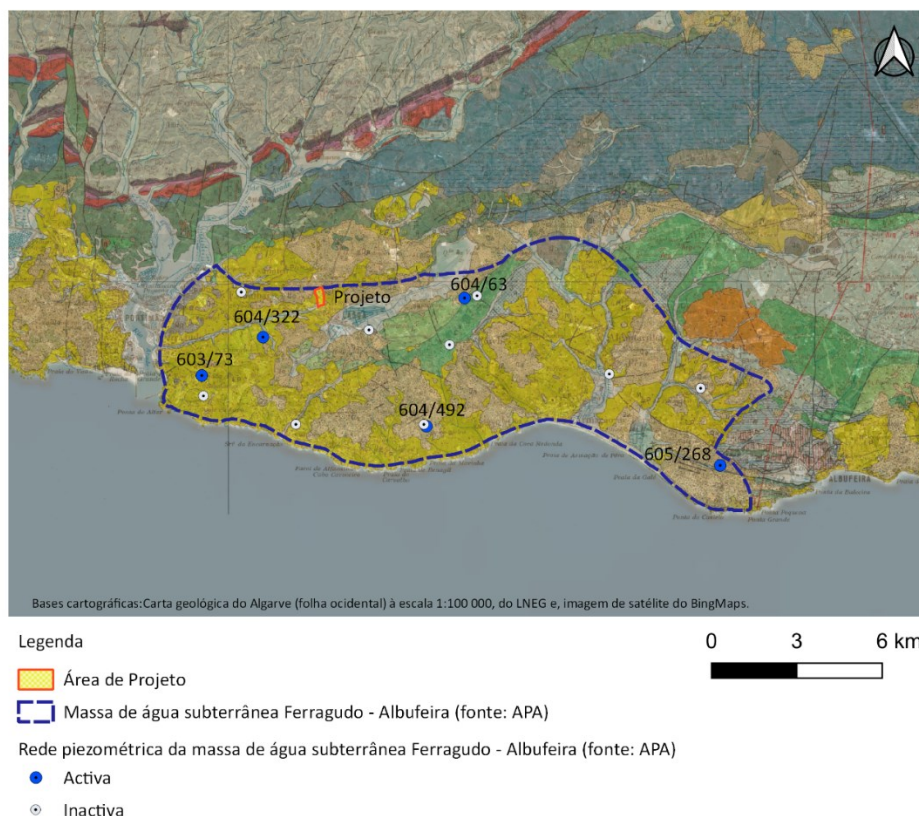
Figura 31. Enquadramento geográfico da massa de água subterrânea Ferragudo - Albufeira e localização da rede piezométrica do SNIRH/APA.
