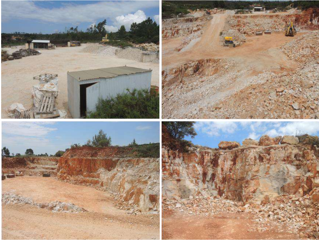
Figura 10. Fotos 1 e 2 (cima esquerda, cima direita) – Vista geral da atual área do projeto licenciada; Foto 5 e 6 (baixo esquerda, baixo direita) – Bancada de exploração localizada junto ao limite SE e pormenor da fracturação de superfície.
