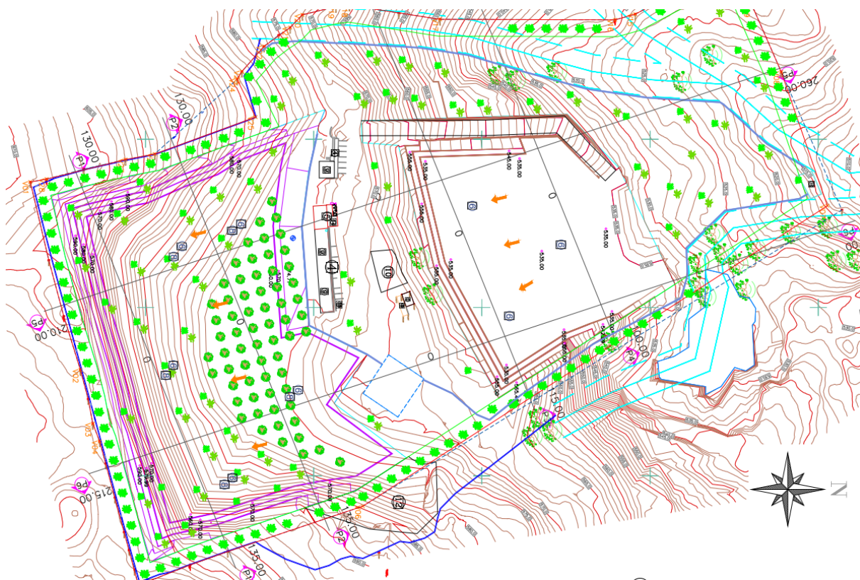
Figura 1 - Planta de Escavação Final
