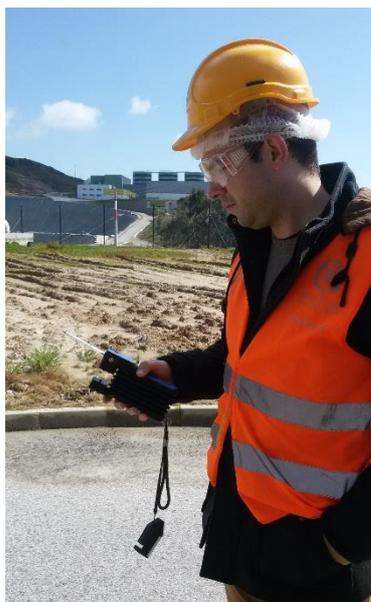
Figura 6 – Medição com recurso tubo colorimétrico  $H_2S$
