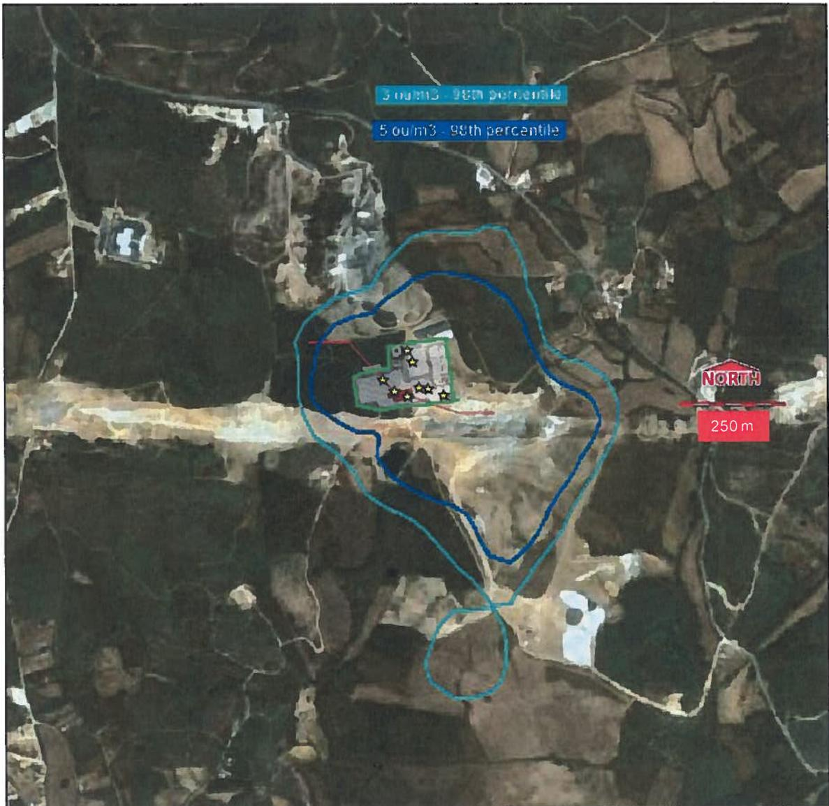
Figura 5: Resultados da modelação do impacto das emissões odoríferas da futura CVO de Mafra para o Cenário 2. O contorno a azul claro corresponde ao nível de emissão de  $C_{08,1hora} = 3 \text{ oue/m}^3$  e o contorno azul escuro ao nível de emissão de  $C_{08,1hora} = 5 \text{ oue/m}^3$ . O perímetro que delimita a localização da futura CVO encontra-se representado a verde.
