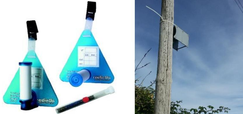
**Figura 2 - Tubos de difusão *standard* da Radiello e exemplo de colocação de equipamento de monitorização passiva em ar ambiente**
