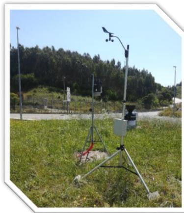
Figura 3 – Estação Meteorológica Davis Vantage Pro instalada no Ecoparque da Abrunheira
