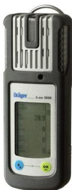
Figura 5 – Equipamento de medição de  $H_2S$
