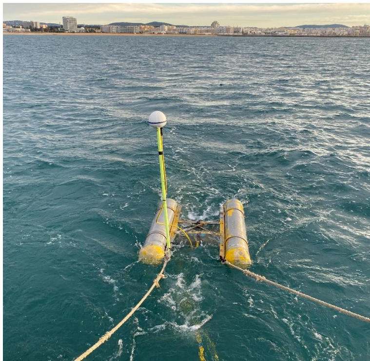
Figura 3. Equipamento utilizado durante o levantamento geofísico, sistema Boomer com DGPS.
