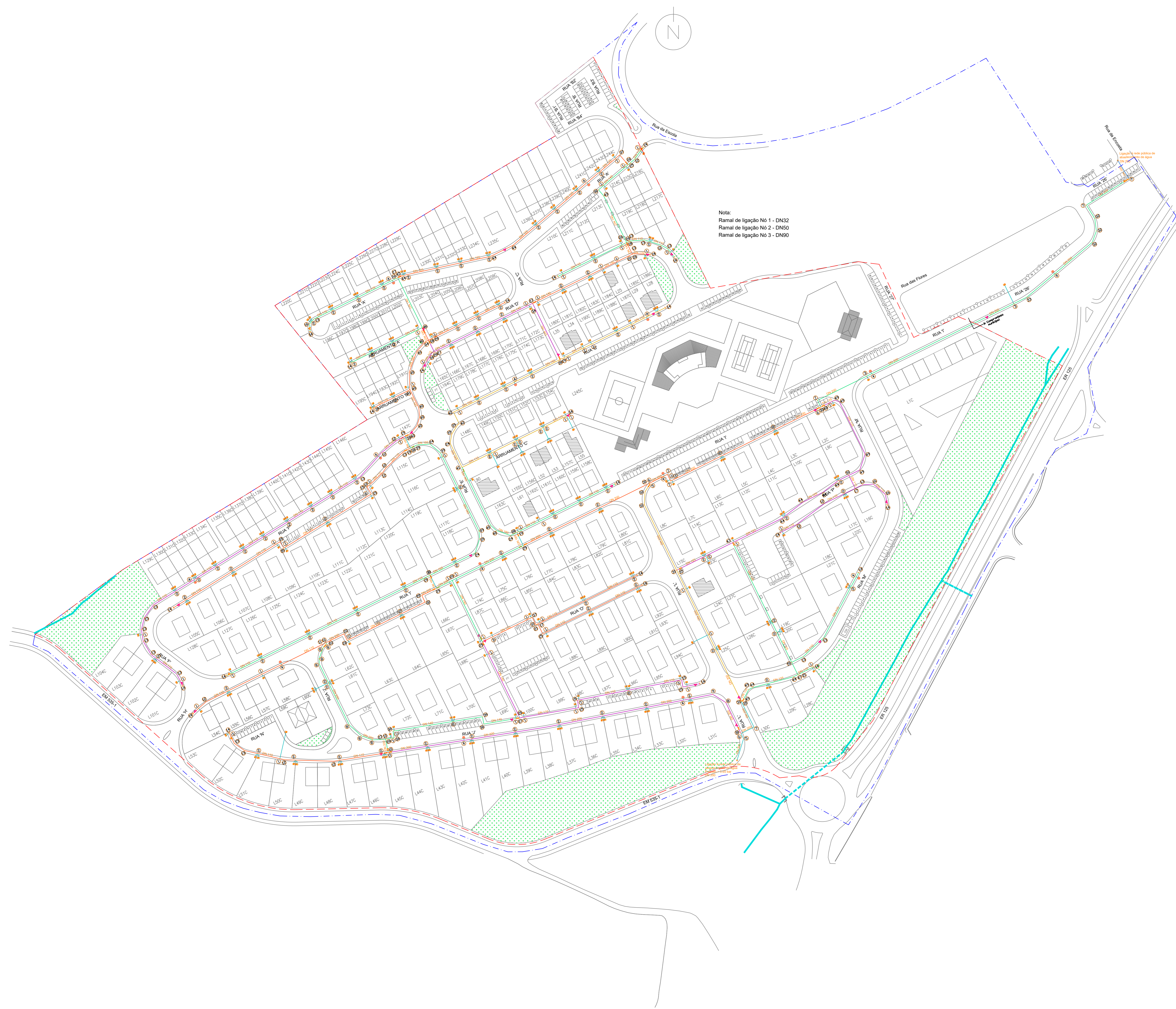
Planta geral das zonas de seccionamento da rede Escala 1:1000
