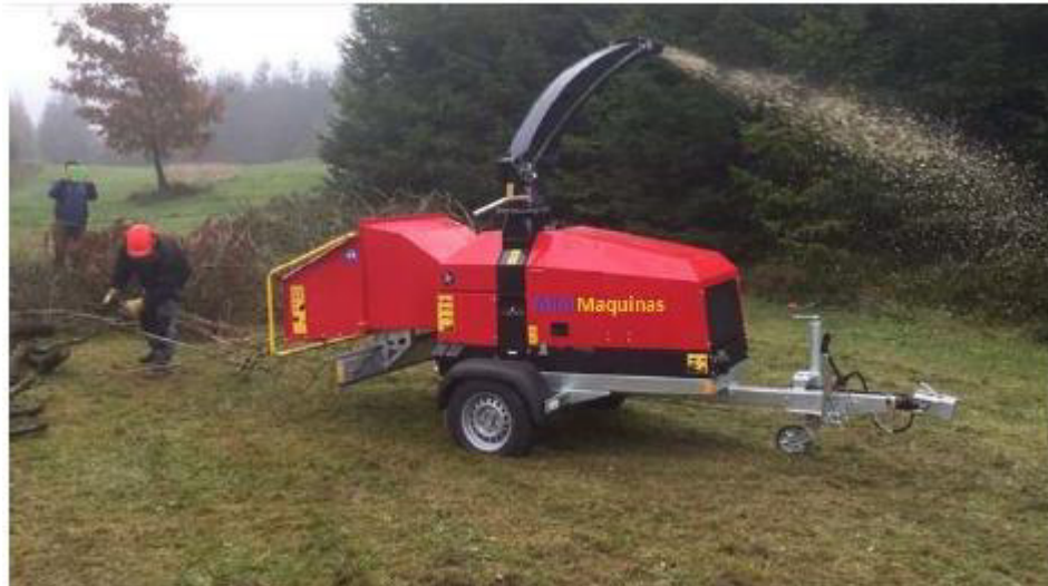
Figura 4.4 – Exemplo de máquina a usar na fragmentação e espalhamentos do material lenhoso e não lenhoso.
