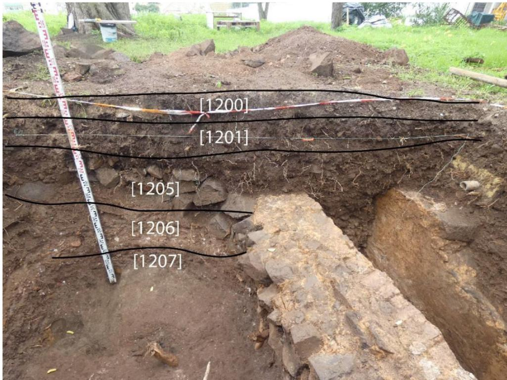
**Figura 58 - Corte Sul da sondagem 12."**
