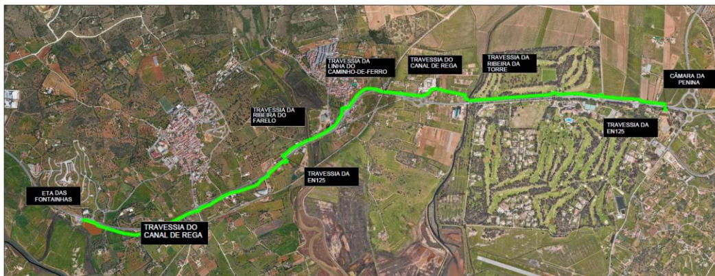
Figura 4.2 – Localização geral da nova conduta adutora
