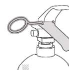
Experimente o extintor carregando na válvula de descarga.
