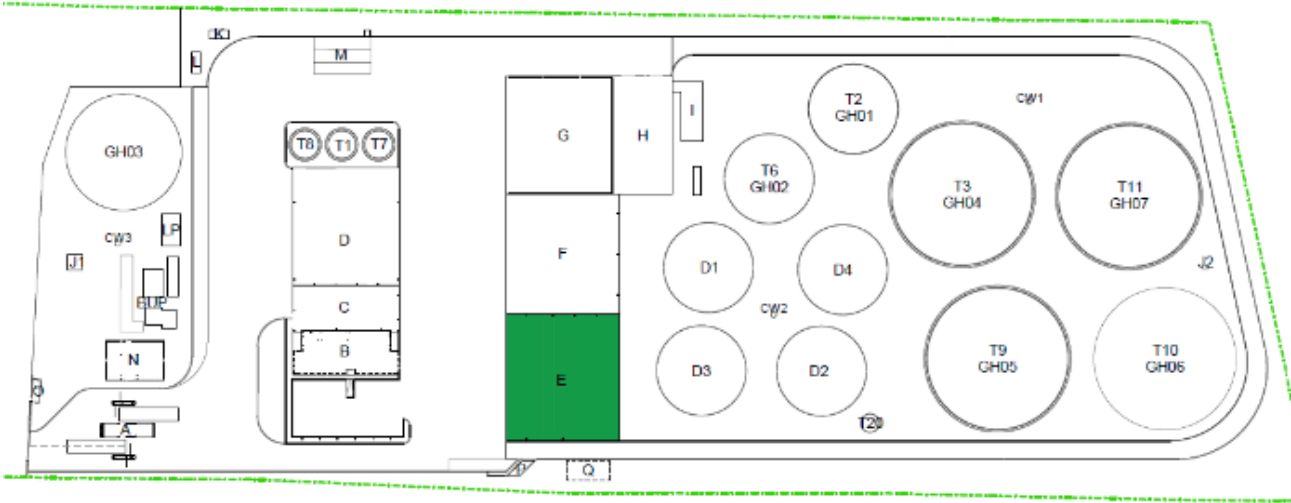
Figura 24. Localização no layout dos tanques de higienização.
