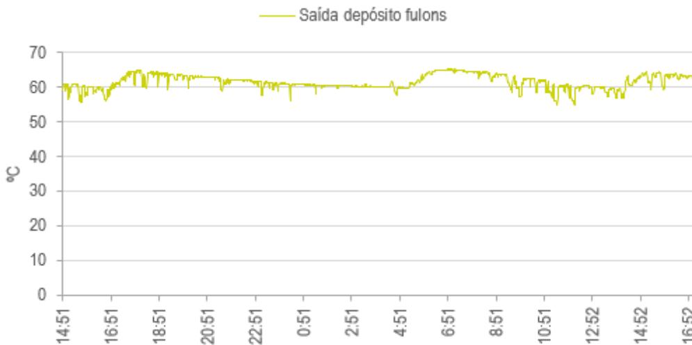
Figura 5.12 – Temperatura da água à saída do depósito de água quente para os Fulons da Ribeira
