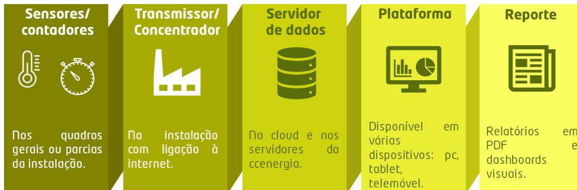
**Figura 6.1 – Diagrama de funcionamento do SMC**
