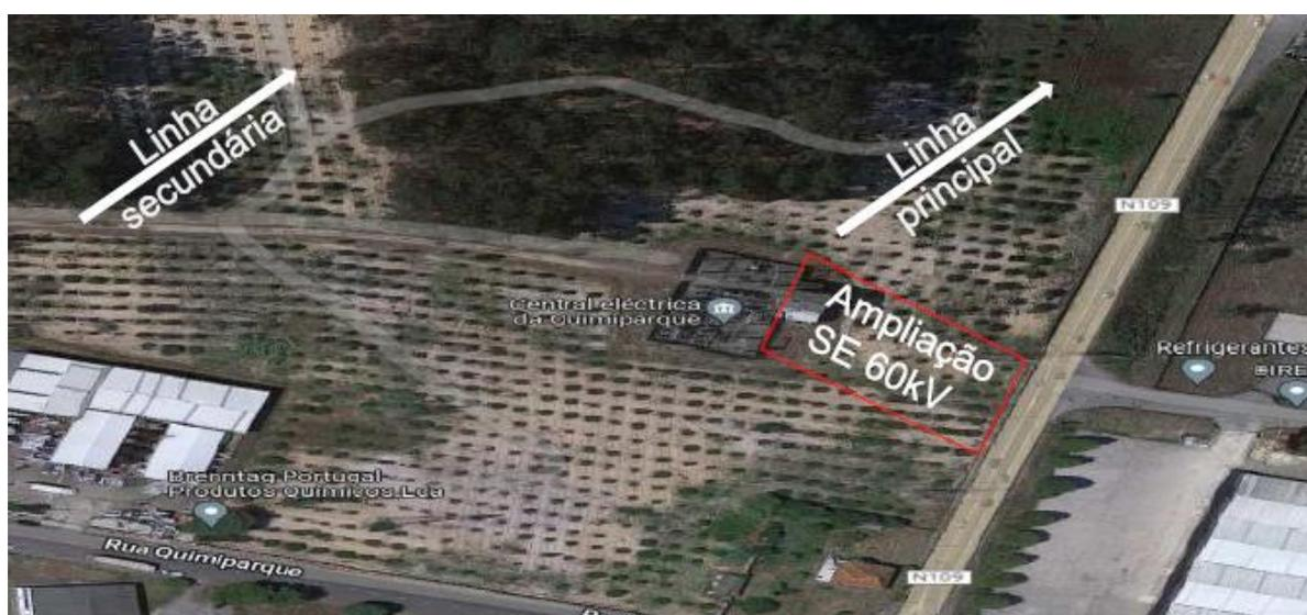
Figura 3.10 – Localização da ampliação da Subestação PCA (Projeto 8)
