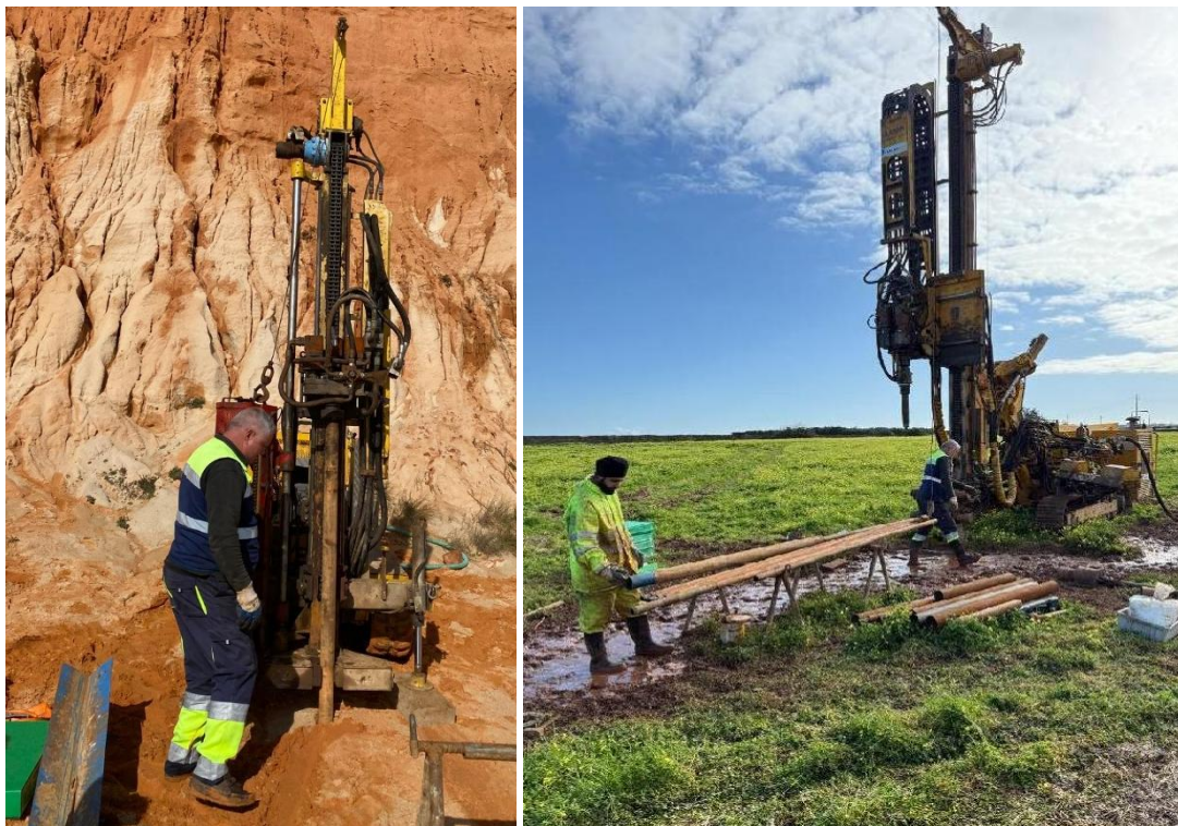
Figura 7: Equipamento de furação Pagani P250 (à direita) e Klemm 805 (à esquerda).
