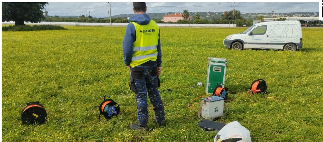
Figura 12: Execução de sondagem elétrica vertical - Método de Wenner.
