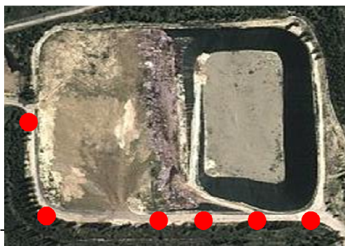
Figura 20 – Localização das bocas de incêndio no Aterro de Resíduos Sólidos Industriais
