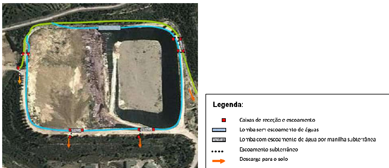
Figura 19 – Rede de Drenagem no Aterro de Resíduos Sólidos Industriais
