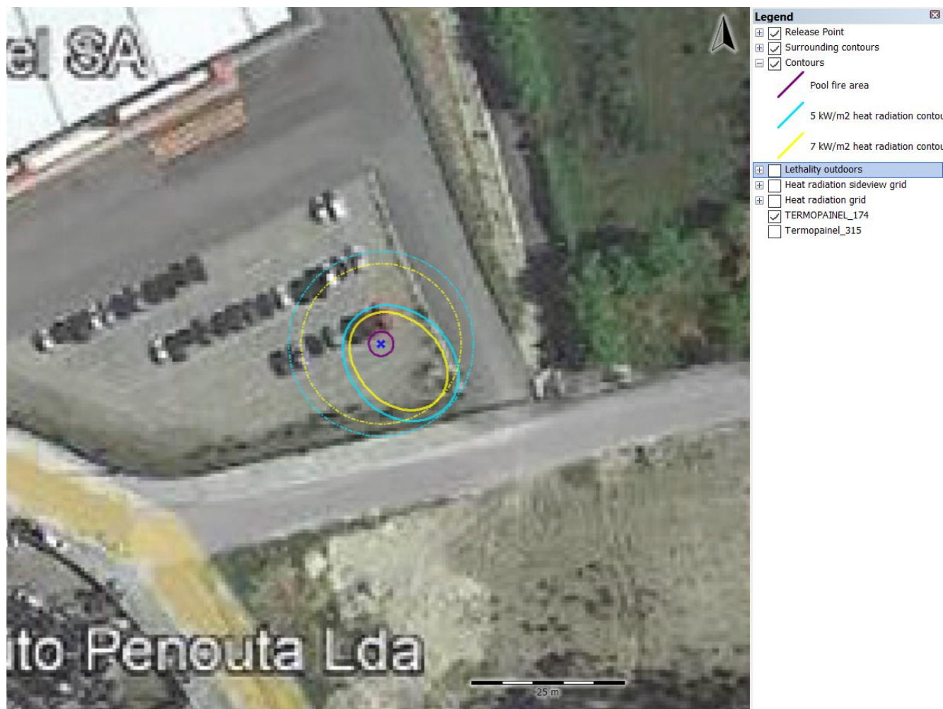
Figura 4 - Rotura parcial de mangueira de abastecimento de Propano. Incêndio de derrame
