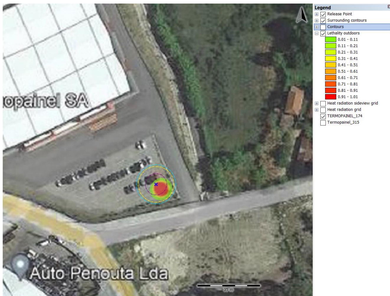
Figura 2 - Rotura 10% do diâmetro de mangueira de descarga de propano. Probabilidade de ocorrência de fatalidades
