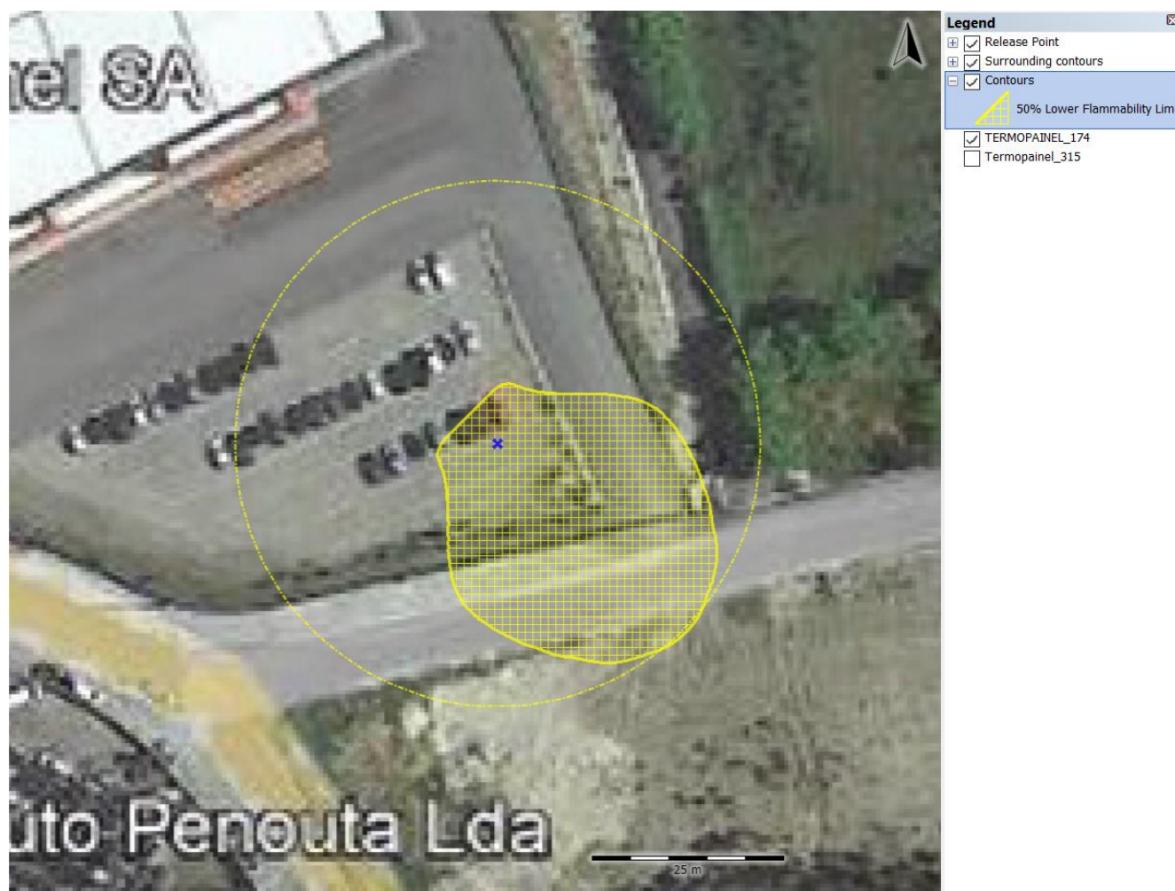
Figura 3 - Rotura parcial de mangueira de propano. Alcance do LII/2
