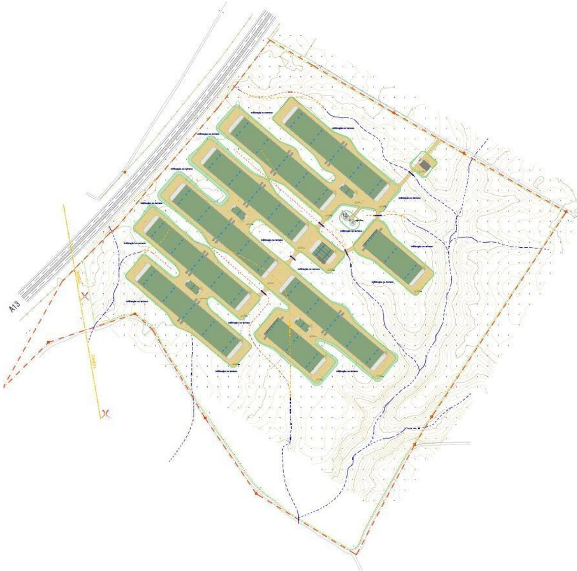
As plataformas onde se pretende implantar os pavilhões avícolas e respetivos edifícios de apoio sobrepõem-se a algumas das linhas de água secundárias. Para colmatar essa sobreposição está previsto a alteração do traçado das linhas de água que drenam para uma bacia hidrográfica maior, que nasce fora da propriedade e que tem maior expressão no terreno, através da sua renaturalização.
