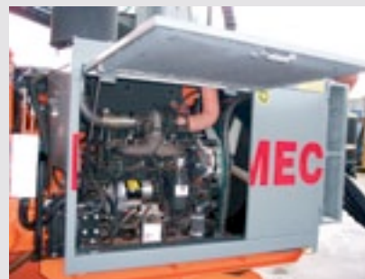
■ Gruppo motore con carter insonorizzato, raffreddamento ad acqua Engine group with sound-proof casing, liquid cooled
