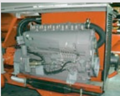
■ Gruppo motore con carter insonorizzato, raffreddamento ad aria Engine group with sound-proof casing, air cooled
