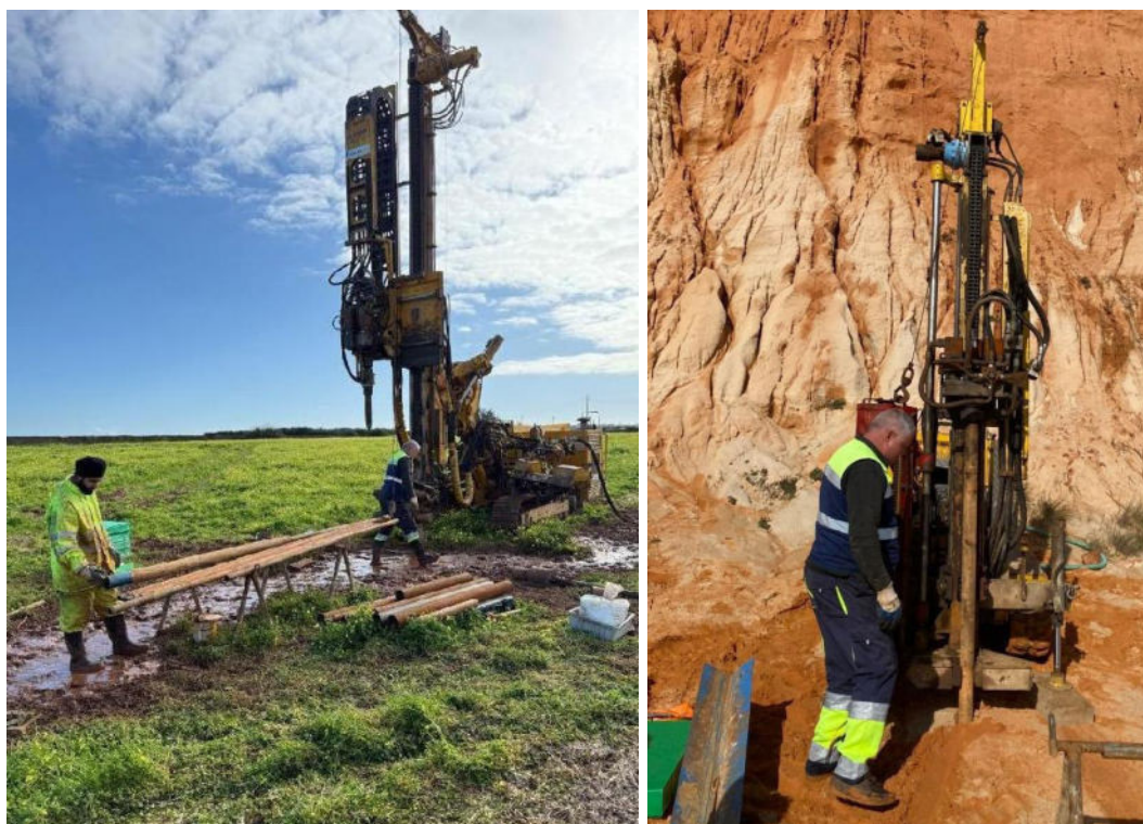
Figura 7: Equipamento de furação Klemm 805 (à esquerda) e Pagani P250 (à direita).
