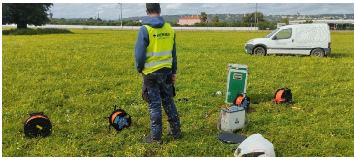
Figura 12: Execução de sondagem eléctrica vertical - Método de Wenner.
