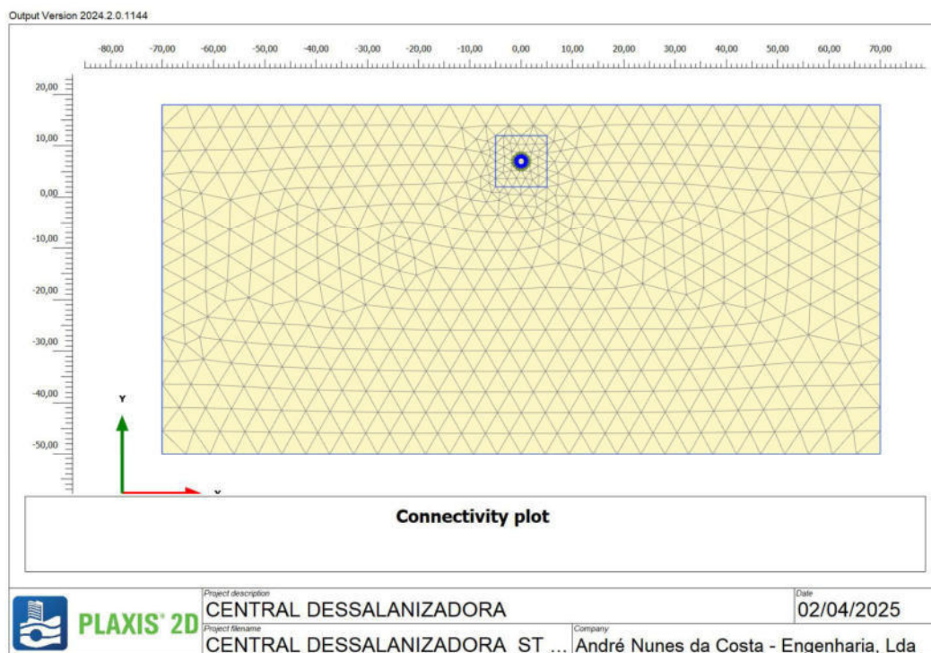
Figura 4 – Malha de elementos finitos do modelo de análise da construção da conduta. Recobrimento de 11.0m
