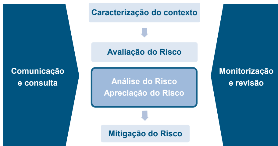
Figura 4.1 – Processo geral da gestão de risco (adaptado da Norma ISO 31000:2018).
