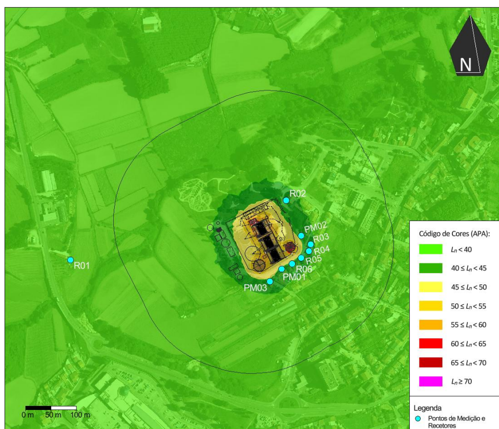
Figura 2.3 – Mapa de Ruído desenvolvido para o Indicador L_n para a área de Expansão da ETAR.
