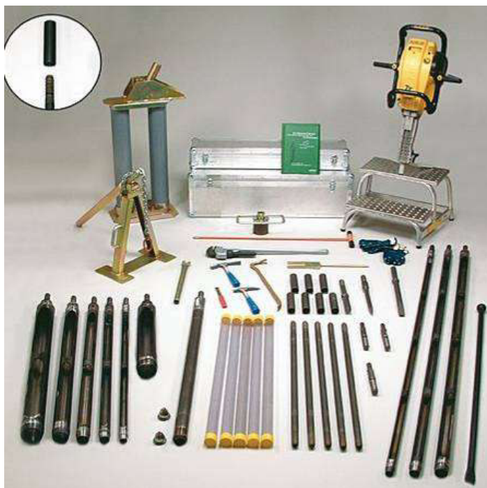
Figura 4 – Equipamento de recolha de solos à percussão.
