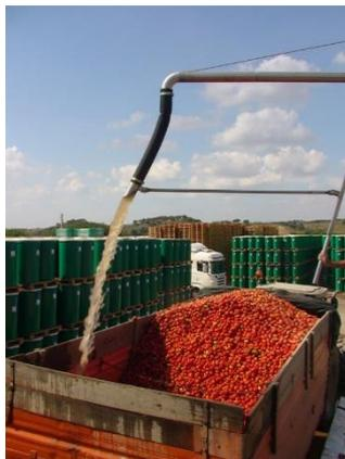
Fotografia 4.2 Processo de descarga de matéria-prima
