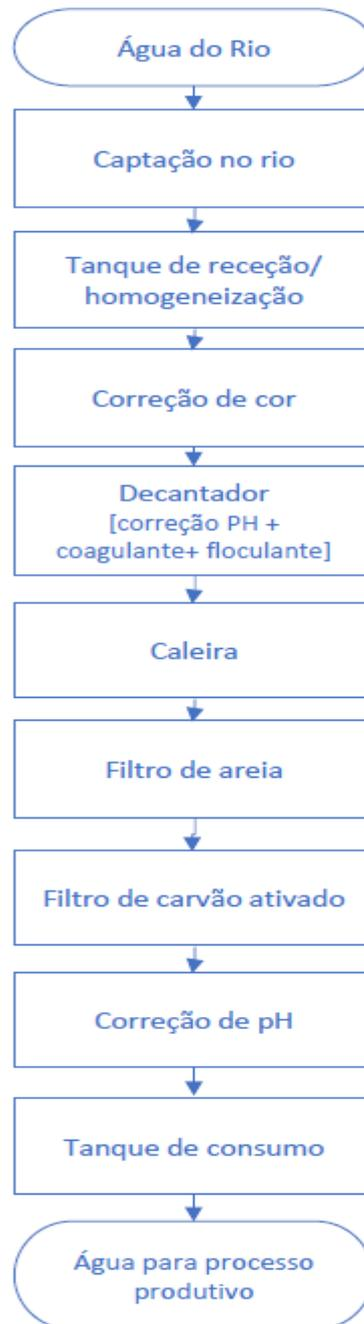
Figura 6 – Diagrama de fluxo do tratamento realizado à água superficial captada na Endutex – Tinturaria e Acabamento de Malhas S.A.
