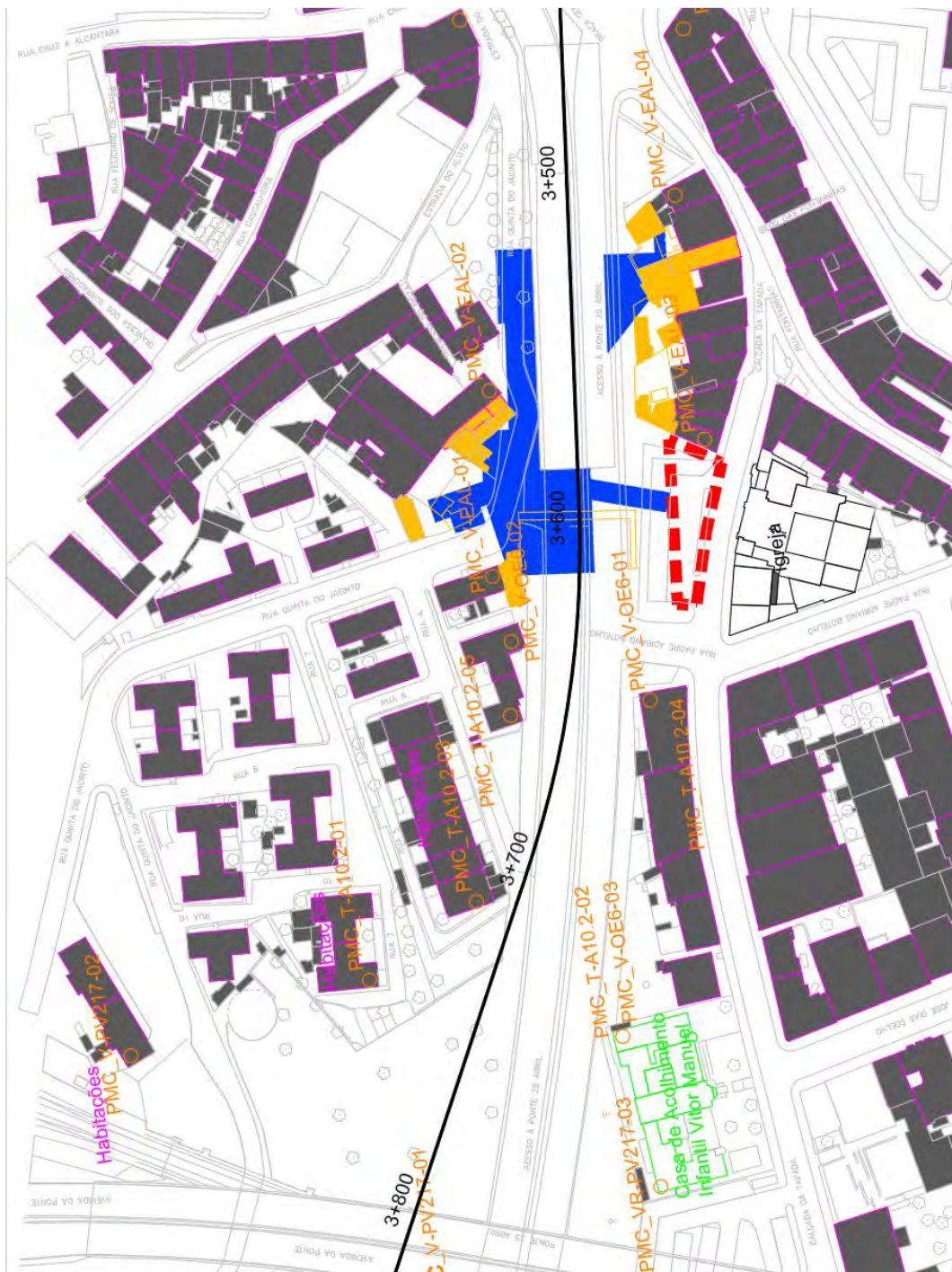
Figura 8: Localização dos Estaleiros EAL e frentes EAL e OE6 e envoltivo, e identificação dos pontos de monitorização na fase de construção, vibração (PMC_V) e vibração e ruído (PMC_VR) propostos
