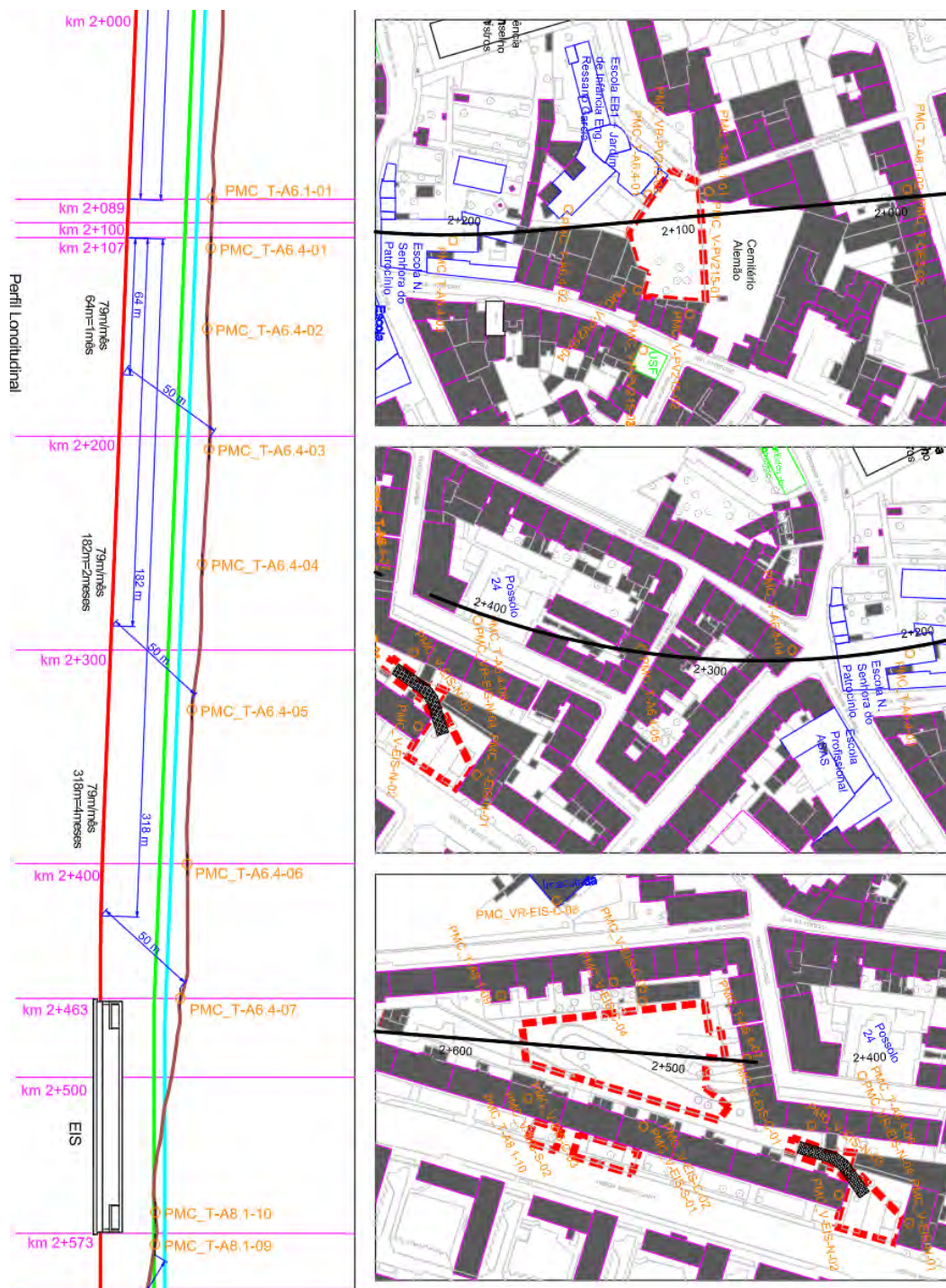
Figura 14: Perfil longitudinal e Plantas, com localização dos Pontos de Monitorização Contínua associados à frente de túnel A6.4
