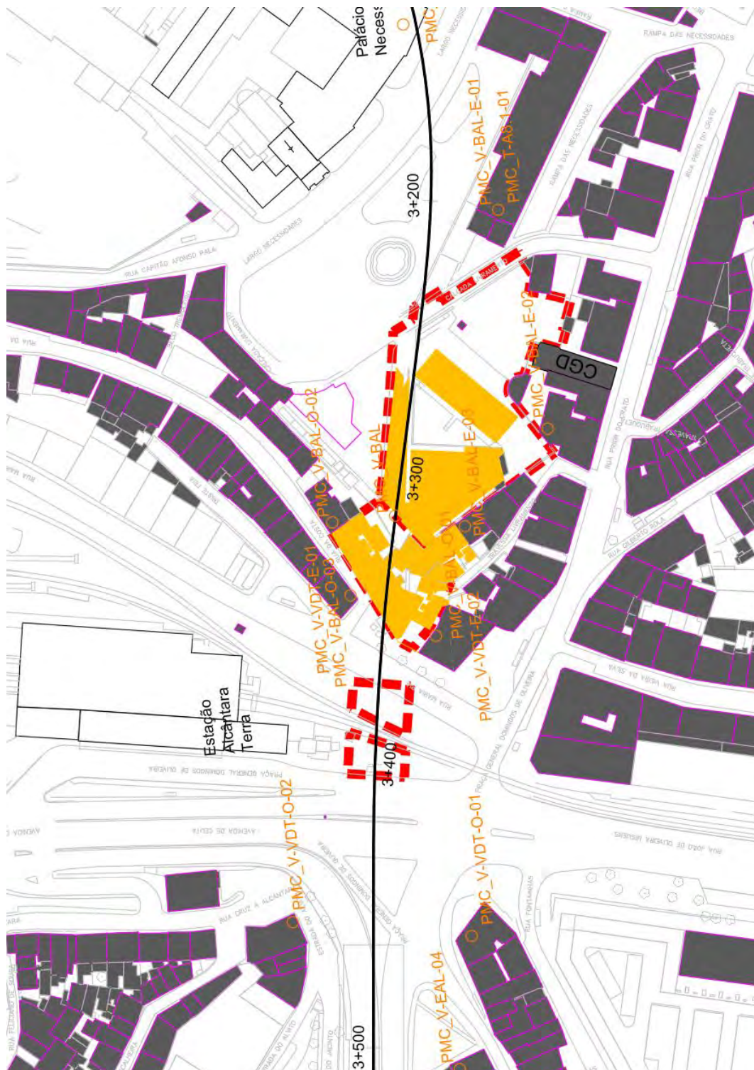
Figura 7: Localização dos Estaleiros BAL-E, BAL-O, VDT-E e VDT-O e envolvente, e identificação dos pontos de monitorização na fase de construção, vibração (PMC_V) propostos
