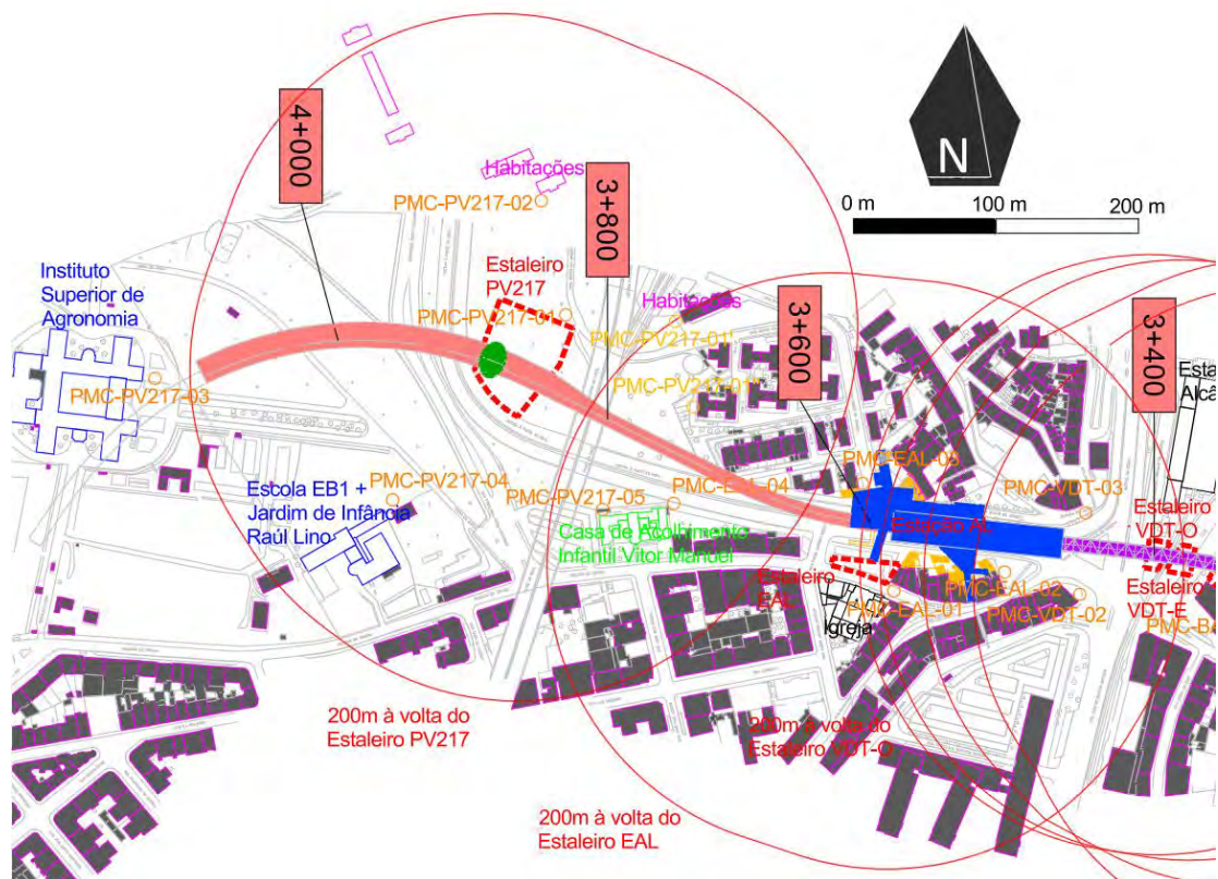
Figura 23: Localização do Estaleiro do Poço de Ventilação 217 (PV217) e envolvente, e identificação dos pontos monitorização na fase de construção (PMC) propostos
