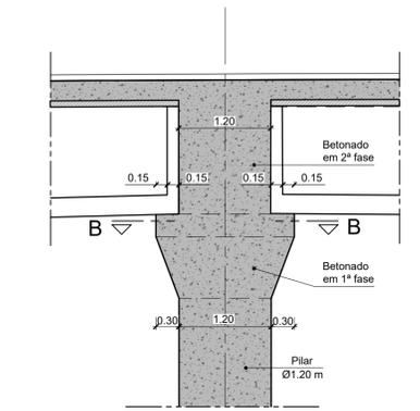
CORTE LONGITUDINAL NO EIXO DOS PILARES
