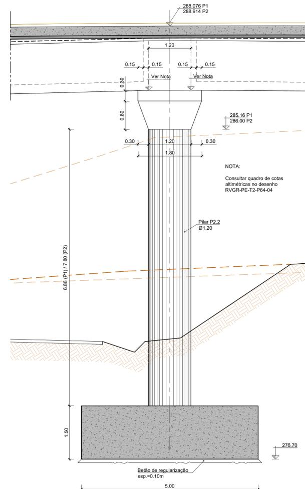
CORTE LONGITUDINAL A-A - PILAR P2
