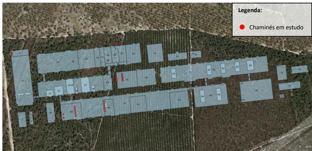
Figura 2.2 – Apresentação dos obstáculos inseridos no raio de 300 metros, a partir das fontes em estudo, com foco nos edifícios da própria instalação (Imagem do ano 2023 do Google Earth )
