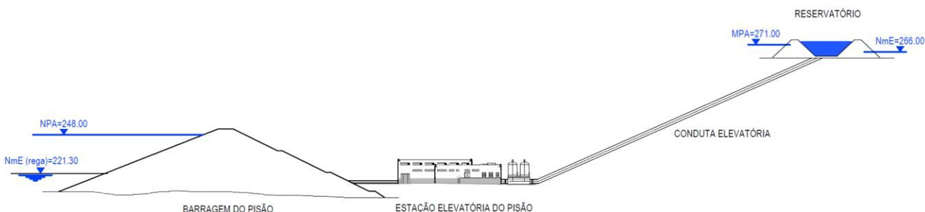
**Figura 2.2 – Esquema do sistema de adução**
