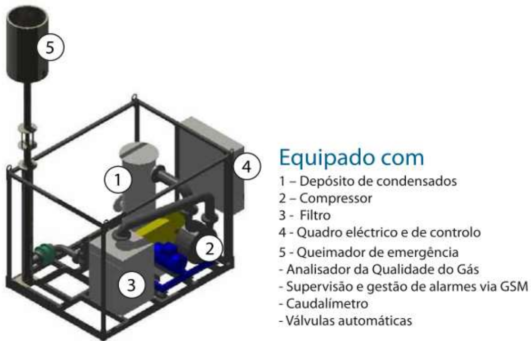
Figura 8 – Exemplo de uma unidade de aspiração e queima de biogás
