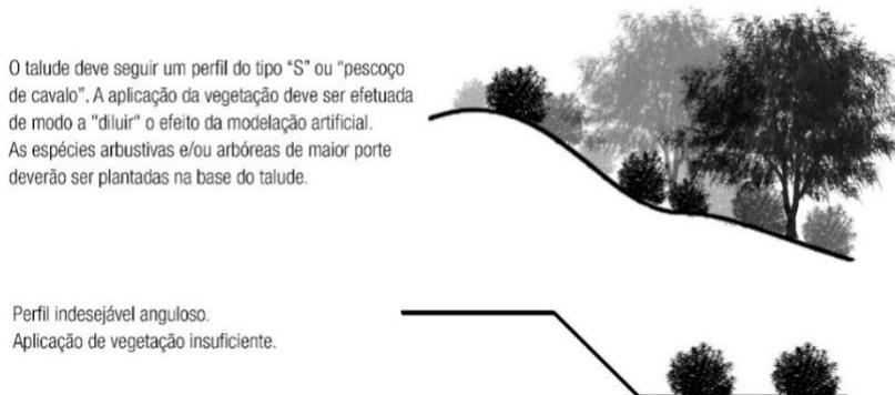
Figura 30. Integração de taludes.
