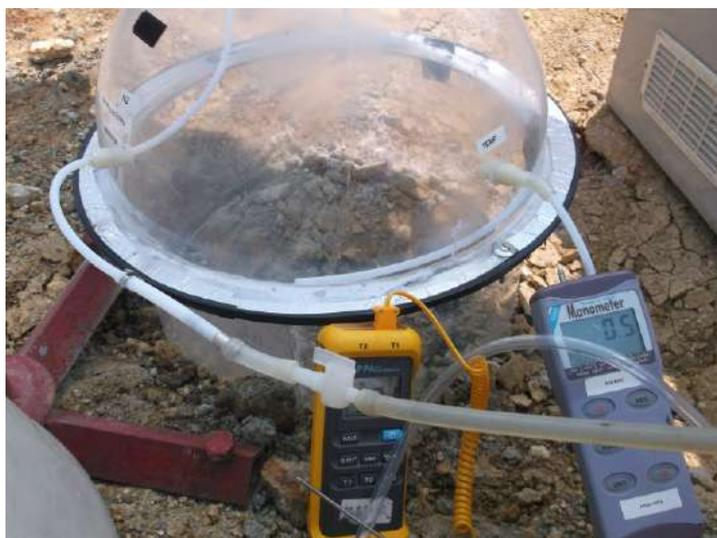
Fig. 1 - Caixa de fluxo ODOFLUX®
