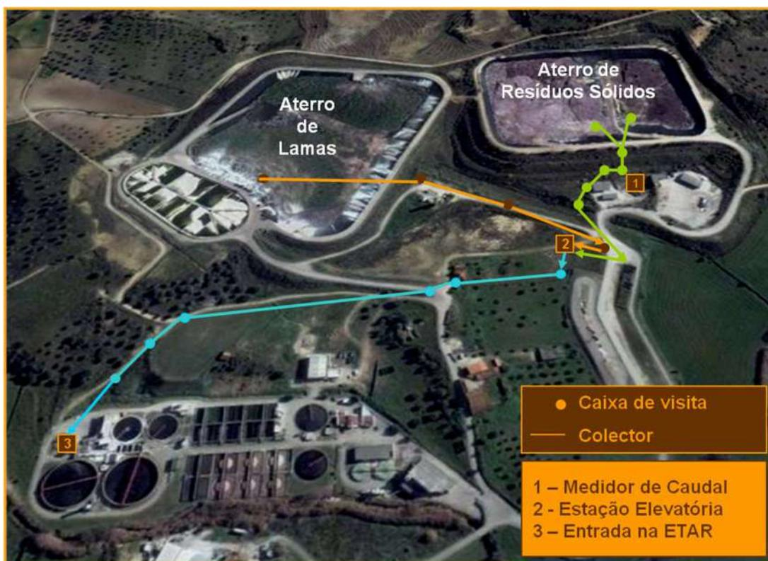
Figura 10 - Rede de drenagem dos lixiviados, desde as células do aterro até á entrada da ETAR.
