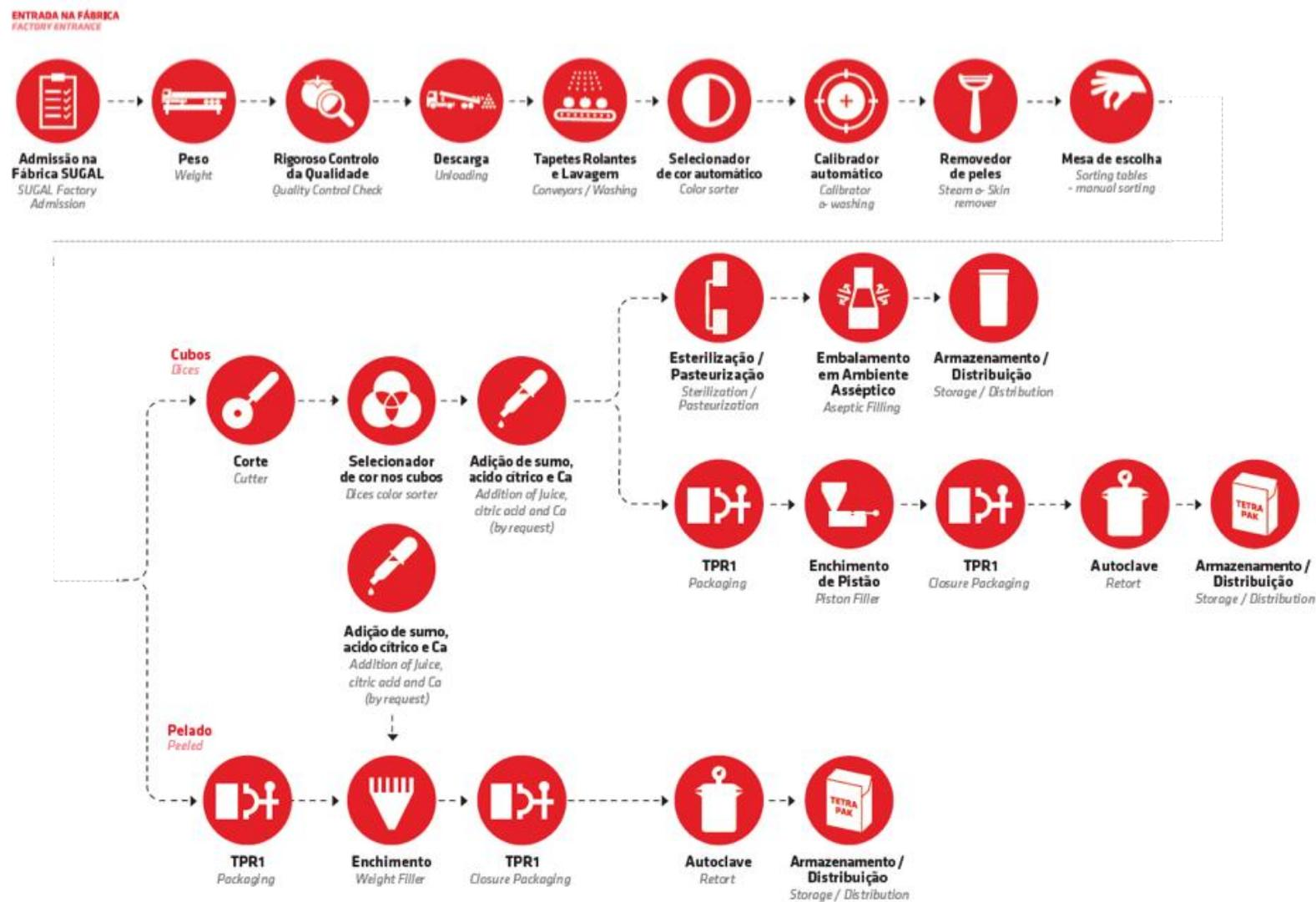
Figura 5 – Ciclo de processamento de cubos de tomate e pelado
