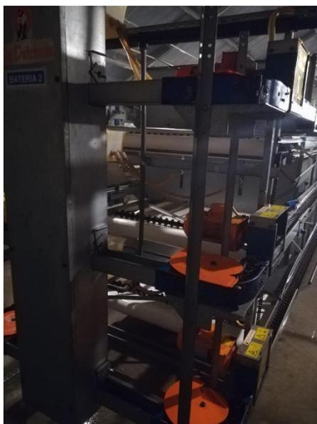
**Figura 3.8 – Sistema automático de distribuição de ração**
