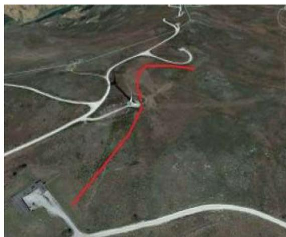
Fotografia 2- Trajeto da vala de cabos do Sobreequipamento do Parque Eólico de Fonte da Mesa recentemente instalada
