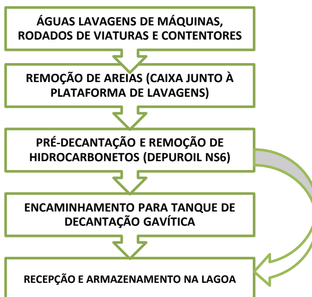
Figura 4 – Esquema de tratamento – águas residuais com hidrocarbonetos (1)
