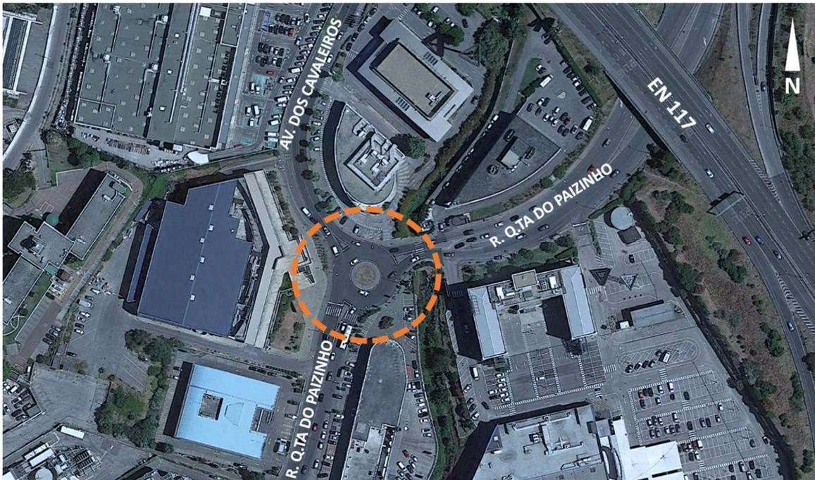
Este projeto tem como objetivo, a reformulação da rotunda identificada na figura acima, garantindo um aumento de capacidade de escoamento da rotunda, com o aumento do raio exterior da rotunda e passagem de todas as entradas e saídas para duas vias por sentido.
