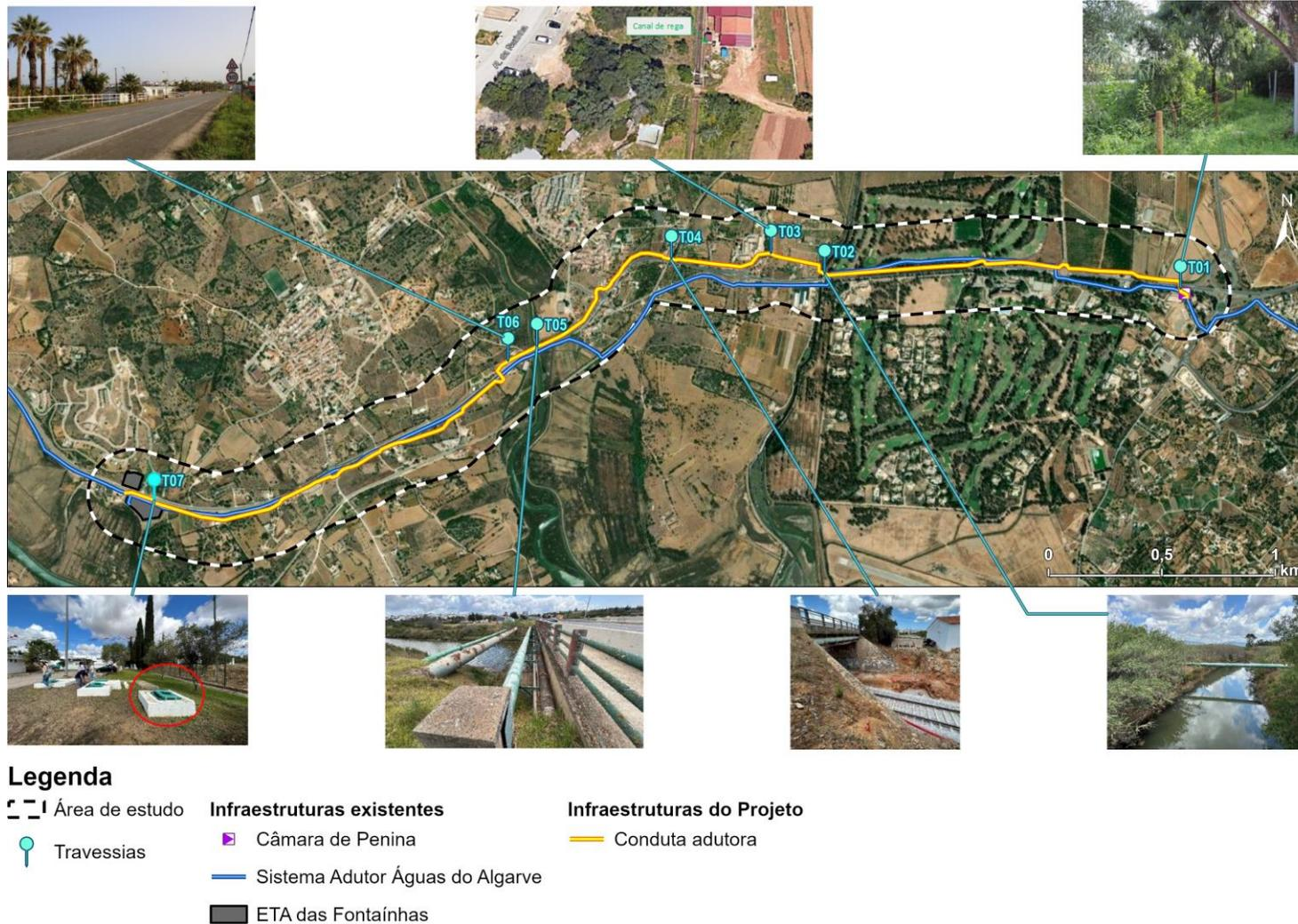
Figura 4.3 – Travessias da conduta adutora com as várias interferências identificadas.
