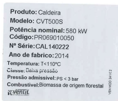
Figura 1: Placa identificativa do sistema de aquecimento existente na exploração
