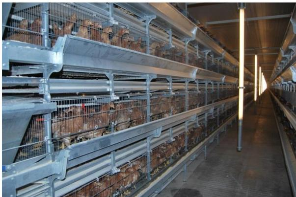
**Figura 3** – Jaulas de alojamento das aves, visualizando-se as calhas dos comedouros
